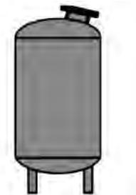
Für den Zugang mit PSA gegen Absturz bzw. mit PSA zum Retten empfohlene Mindestmaße für Mannloch: 800mm Durchmesser bzw. wenn die Stützhöhe 250 mm nicht übersteigt: 600mm Durchmesser
