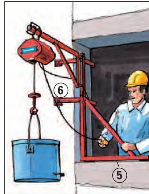
– für die seitliche Befestigung mindestens 24 cm dickes, belastetes Mauerwerk vorhanden ist ⑥.
